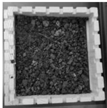
Figura 3.0 Na primeira camada dos materiais permeáveis utiliza-se pedra fina.
